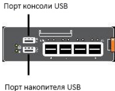
Рисунок 2. Порты USB на передней панели
